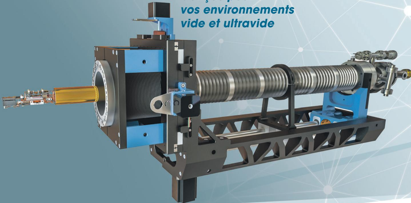
Développés pour l'environnement vide et ultravide, les manipulateurs CRYOSCAN permettent de couvrir une gamme de températures de 8 K à 1500 K. En fonction de vos besoins, des versions 4, 5 ou 6 axes peuvent être personnalisées. Nos manipulateurs peuvent être équipés de cryostats à circulation d'hélium ou d'azote pour le refroidissement et d'éléments chauffants radiatifs ou par faisceau d'électrons.
